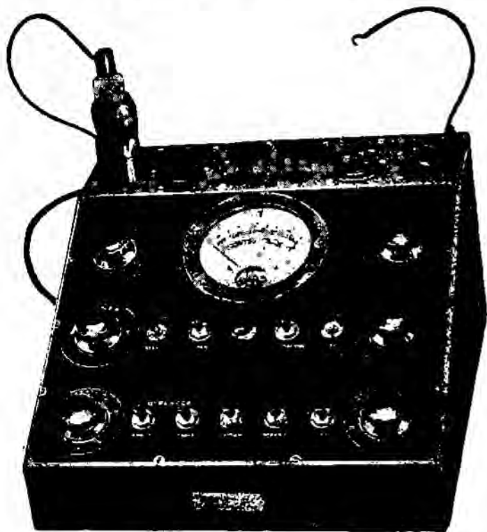
Fig. 144. — Prova tubi elettronici (Pontremoli).
